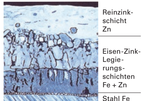
Schliffbild eines Zinküberzuges, ca. 200:1
